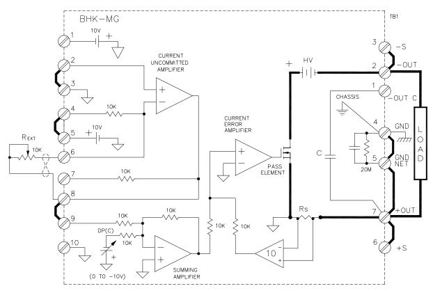
NOTE: UNIT SHOWN IN FAST MODE, +OUT TERMINAL GROUNDED, LOCAL SENSING.
