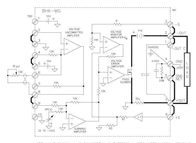
NOTE: UNIT SHOWN IN SLOW MODE, +OUT TERMINAL GROUNDED, LOCAL SENSING.
