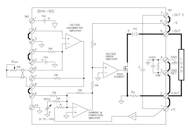
NOTE: UNIT SHOWN IN SLOW MODE, +OUT TERMINAL GROUNDED, LOCAL SENSING.
