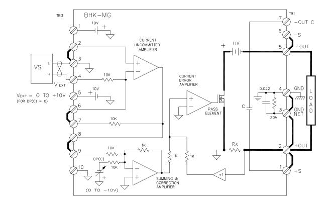
NOTES: 1. UNIT SHOWN IN FAST MODE, +OUT TERMINAL GROUNDED, LOCAL SENSING.
